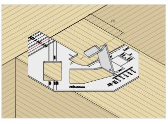
MAIN-BEAM-SECONDARY BEAM JOINT
